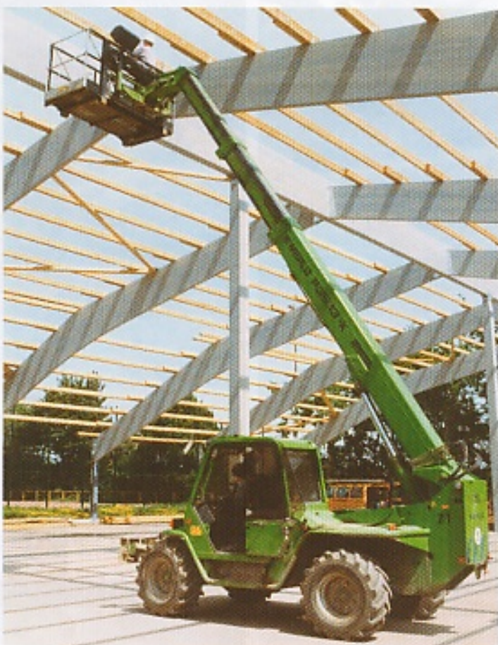
Die Teleskopmaschine P35.13 K von Merlo war in Hohenroda mit einer Hubarbeitsbühne ausgestattet, die über eine Grundbreite von 2,35 m verfügt, die manuell auf 4,5 m ausziehbar ist.
