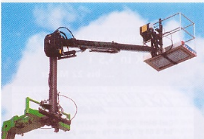
Die Merlo-Space-Bühne. Auf den Platformers' Days war diese vielseitige Arbeitsbühne an einem Merlo ROTO 45.21 KSC, ein Teleskopstapler mit drehbaren Oberwagen, angebaut.
