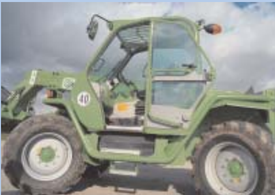
Breite, geräumige Kabine. Gute Sicht durch hohe Sitzposition. Aber Einstiegs- höhe von 100 cm über zwei Stufen.
