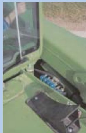
Für alle Fälle: Sollte die Elektrik ausfallen, lassen sich die Hydraulikventile von Hand betätigen.
