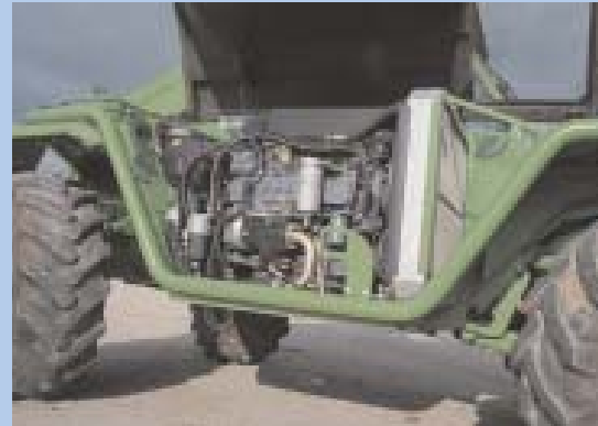
Der 140 PS-Deutz-Vierzylinder ist kräftig dabei. Der Verbrauch von 6,5 bis 7,8 l/h geht für die Power in Ordnung.
