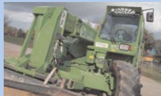
Der Ausleger ist aus zwei U-Schalen zusammengeschweißt. Nasse Bremsen wären haltbarer als trockene.
