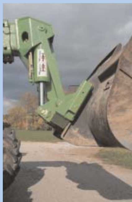
Der Werkzeugzylinder ist direkt angeleitet. Das spart Umlenkhebel. Reißkraft und Kippwinkeln sind in Ordnung.
