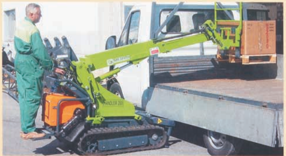
Der neue teleskopierbare Cingo M10 Handler 200 mit 1,5 m Ausladung kann nun auch breite Ladeflächen beschicken. | Foto: Merlo.
